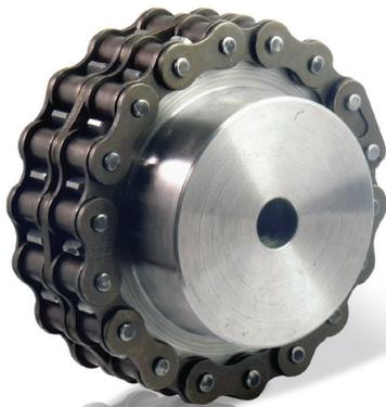
2 pignons acier pour chaîne simple à rouleaux, sont reliés par une chaîne à rouleaux double qui transmet le couple. Cette chaîne est fermée par un maillon raccord démontable. Le désaccouplement des arbres est instantané et les machines peuvent être désengagées sans avoir à les écarter ou à faire coulisser les pignons.
