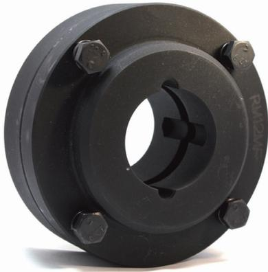
Cet accouplement se compose de **deux parties s'imbriquant l'une dans l'autre**, ceci afin de résister aux glissements dans le sens radial. Ces deux moitiés sont usinées simultanément.
