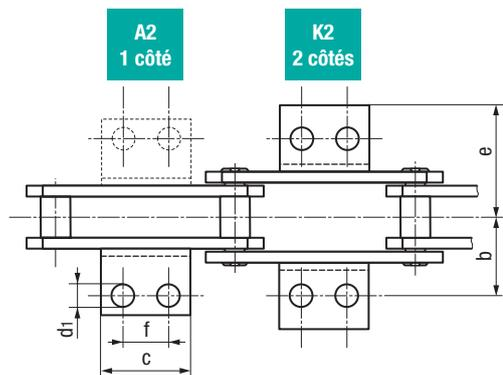
A1 : attache d'1 côté à 1 trou    A2 : à 2 trous    A3 : à 3 trous
