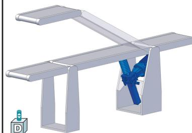
Réglage en hauteur d'une bande transporteuse
