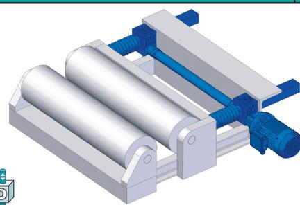
Réglage précis des rouleaux de laminage
