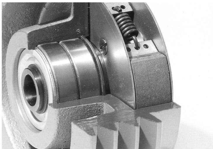
FONCTION LIMITEUR DE COUPLE. Si par hasard, le couple résistant devient anormalement élevé, les garnitures patinent dans la cloche et l'embrayage devient alors " limiteur de couple ". Evidemment, ce patinage ne peut être que très limité dans le temps en raison du dégagement de chaleur qu'il provoque.
