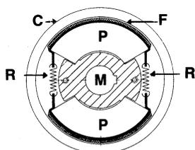
Sous l'effet de la force centrifuge les patins P se décollent du moyeu M (solidaire de l'organe moteur) sur lequel les ressorts R les maintenaient à l'arrêt ou à faible vitesse. Au fur et à mesure que la vitesse augmente, ils embrayent progressivement, par leur garniture de friction F, sur la cloche C (solidaire de l'organe entraîné).
