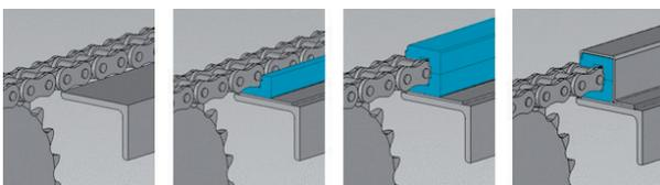
Les profils métalliques existent aussi en version en deux parties qui permettent une mise en place plus facile de la glissière en plastique.
