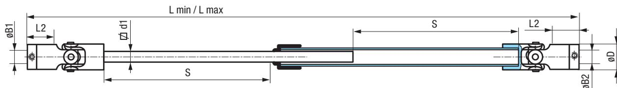
**TYPE AM SÉRIE RENFORCÉE** alésage renforcé par insert métallique à fixer par goupille traversante ou collage (Type Loctite®)
