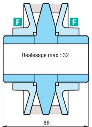
Ces poulies en aluminium permettent par un réglage fin de faire varier leur diamètre supportant la courroie.
