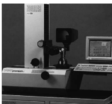
Commande de mouvement sur machine à mesurer (grâce à l'absence de jeu des écrous)
