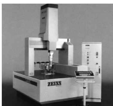
Commande de mouvement sur machine à mesurer (grâce à l'absence de jeu des écrous)
