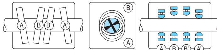
La paire AA' de roulements et la paire BB' agissent sur l'arbre en des points diamétralement opposés. Un jeu de cales CC', en forme de coin leur donne une inclinaison qui conditionne le pas. Le pas ne peut se changer en marche.
