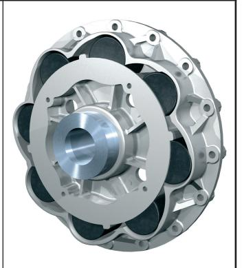
C'est un accouplement simple et robuste à caractéristique torsionnelle progressive. Installé entre le moteur Diesel et le réducteur inverseur c'est un accouplement idéal pour la propulsion des navires car sa faible rigidité dynamique torsionnelle à basse vitesse permet de repousser la fréquence de résonnance en dessous du ralenti.
