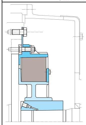
Caractéristique torsionnelle progressive « Fail Safe Device » Rouleaux en élastomère CENTALAN à grande capacité d'amortissement et résistant jusqu'à une température de +100°C.
