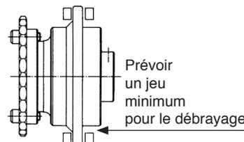
Assujettir un disque sur le limiteur que l'on actionne par une fourchette à commande mécanique, hydraulique, électromagnétique,...
