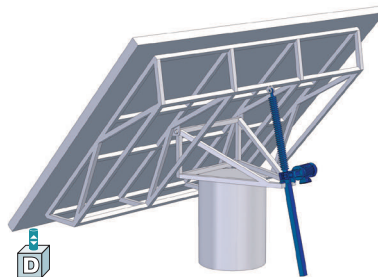
Orientation de panneau solaire
