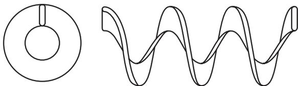
Modèle léger à enfiler sur le tube
