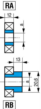
Un tendeur fatigue toujours la courroie qu'il équipe, réduit sa durée de vie ainsi que la puissance transmise.
