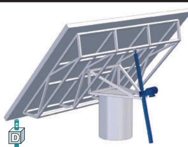
Orientation de panneau solaire
