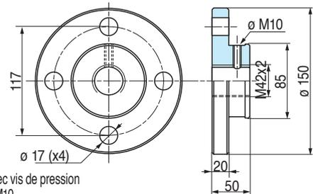
Fourni avec vis de pression perçage M10
