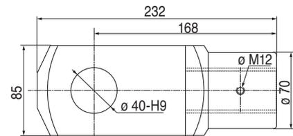
Fourni avec vis de pression perçage M12
