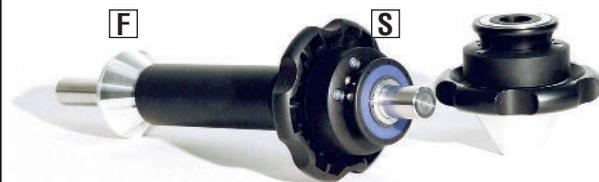
Le système de serrage breveté **UHING EASY-LOCK III®** est constitué d'une bague de serrage qui se coince sur l'arbre sous l'action d'une force axiale (force de serrage).
