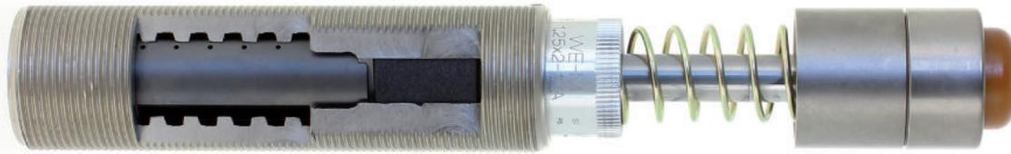
La nouvelle série "Mega-line" possède à partir de la taille 1,25 un corps interne de forme hélicoïdale, ce qui permet un réglage de l'ouverture et de la fermeture des orifices d'étranglement par un coulisement du tube de pression en acier trempé.
