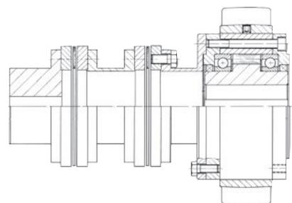
Commande auxiliaire avec roue libre
