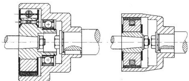
Jonctions d'arbres avec ou sans roulement de centrage incorporé.
