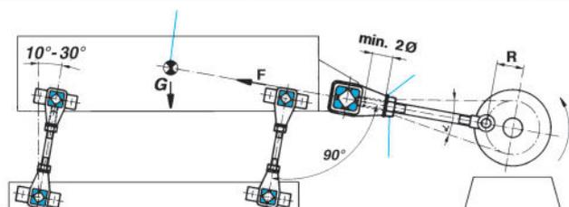
Suivant des valeurs déterminées expérimentalement, l'inclinaison des montants par rapport à la verticale est comprise entre 10° et 30°.
