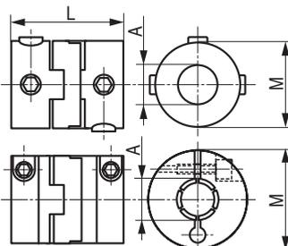
**MOYEU ALU - DISQUE PLASTIQUE ISOLANT SANS JEU - SANS GRAISSAGE**
