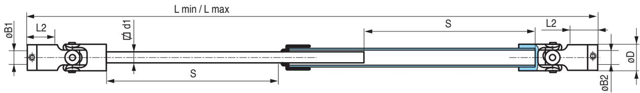
**TYPE AM SÉRIE RENFORCÉE** Alésage renforcé par insert métallique à fixer par goupille traversante ou collage (Type Loctite®)
