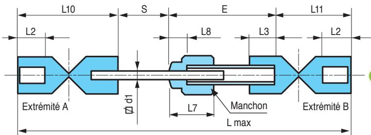
Arbre télescopique équipé d'un manchon antijeu, monté installé.
